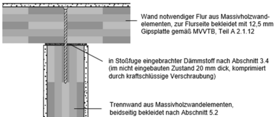
Prinzipskizze 8b: Anschluss Trennwand / Wand notwendiger Flur, Bauteilfuge (Horizontalschnitt)
