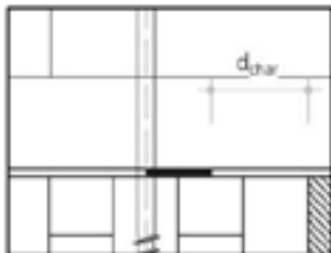
Abbildung 17: Trennwand-Deckenanschlüsse Massivholzbau mit Spaltmaß s \leq 2,0 mm
