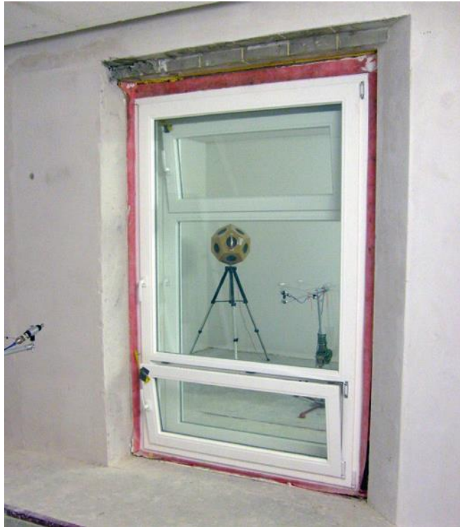
Abbildung 29: Labormessung am „HafenCity-Fenster“ und konstruktive Einbindung [32], Fotoquelle: Grundstücksgesellschaft Shanghaiallee / HafenCity GbR und Zeichnung: Wandel Lorch Architekten
